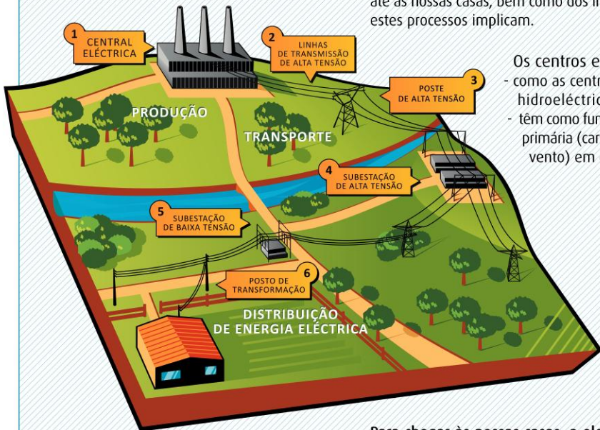
Esquema da produção, transporte e distribuição da energia eléctrica.
